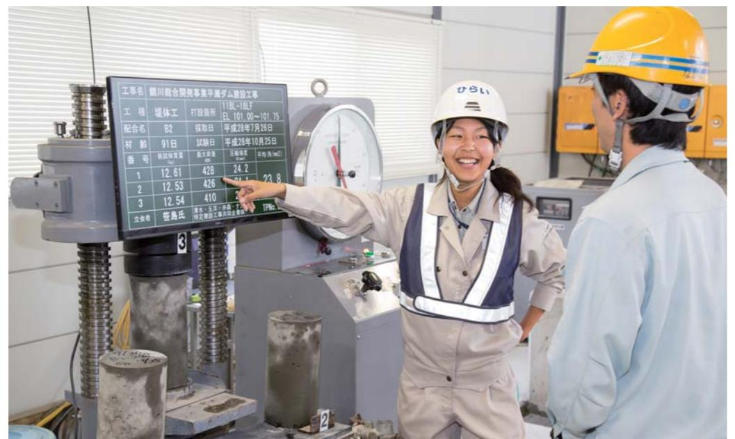
▲打設コンクリートの強度検査を業者さんと協力しながら行う。1日の打設コンクリートは少ない日で500m<sup>3</sup>、多い日は1,000m<sup>3</sup>を使用。
