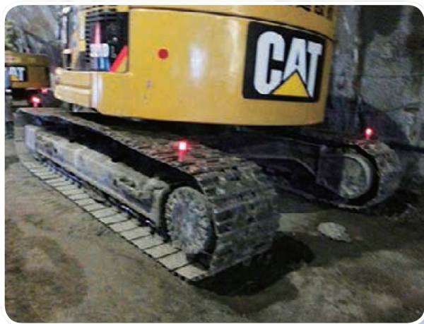
駐機時に四隅へ表示灯を設置
