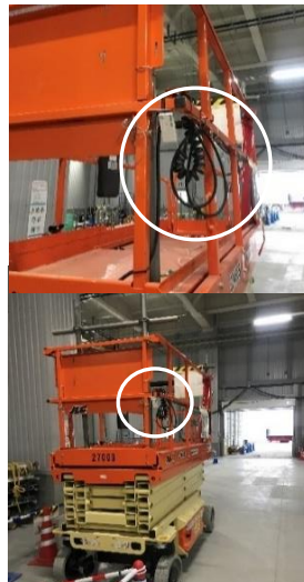
作業車用ビーコンにより、 アプリ上で高車の位置を 見える化
