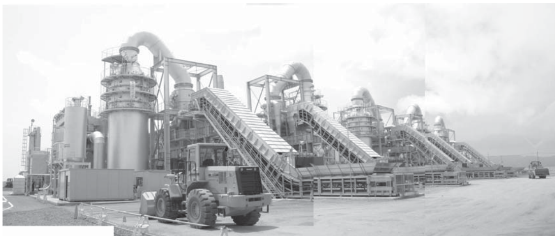
写真—2 亶理処理区二次仮置き場状況（仮設焼却炉100t/日×5基を望む）
