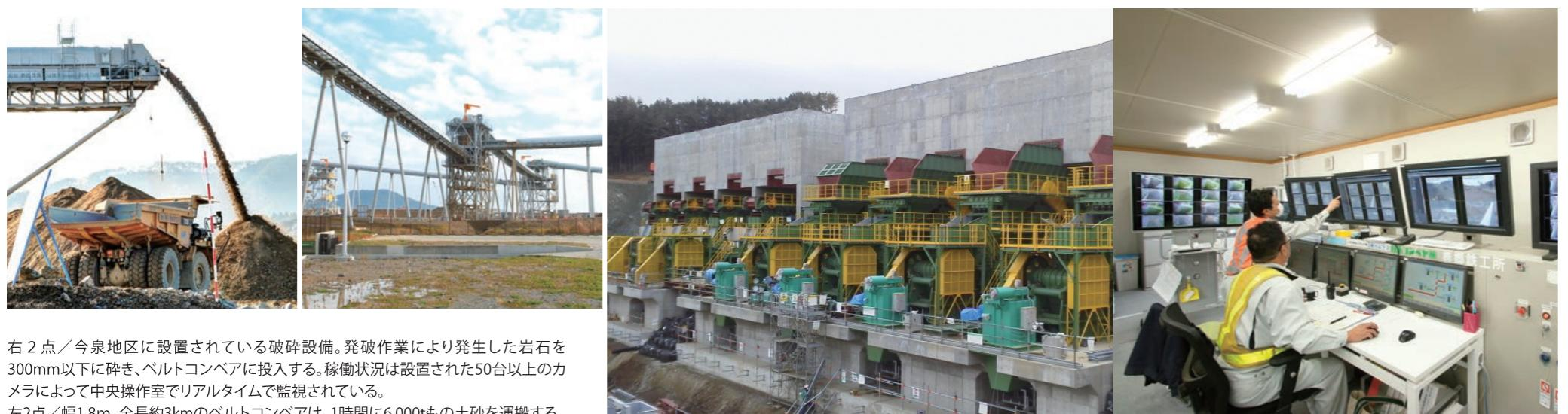
右2点／今泉地区に設置されている破碎設備。発破作業により発生した岩石を300mm以下に砕き、ベルトコンベアに投入する。稼働状況は設置された50台以上のカメラによって中央操作室でリアルタイムで監視されている。
