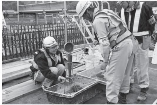
右/ PCグラウトの流動性をチェックするフロー試験。天候の変化への対応や養生の段取りなど、多くの経験を積んでいる。
