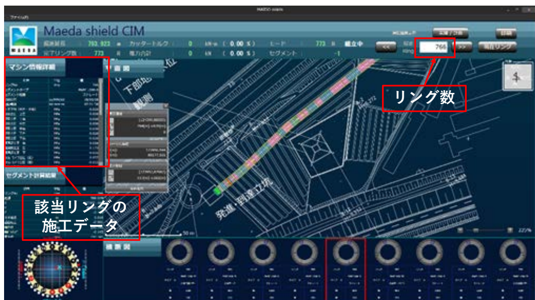
図-3 3D モデルデータと施工情報の紐付け
