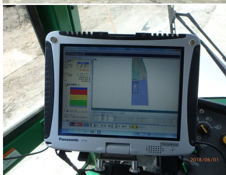
写真.3 GNSSローラー・転圧管理システム
