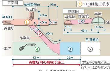
図-2 作業坑の取付け方
