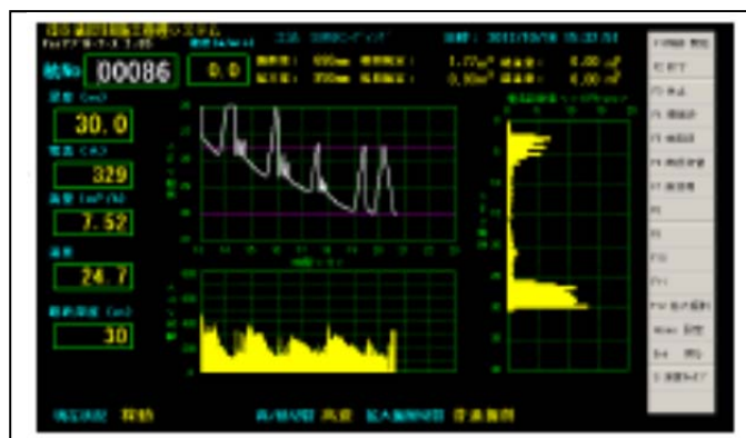
図-3.4 施工サイクルと電流値や注入量データ出力の統合的出力事例
