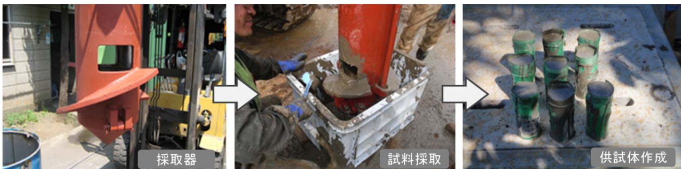
写真-4.3 未固結試料の採取～供試体作成例
