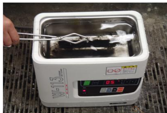
写真 2 超音波洗浄機による汚染物質の除去
