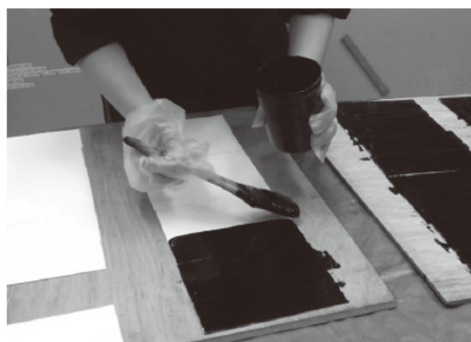
② 汚れ物質の付着（刷毛塗り）
