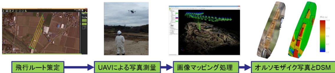
(b) UAV写真測量を用いた土量管理
