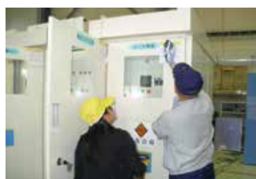
設計した受変電設備を 工場にて検査中。
