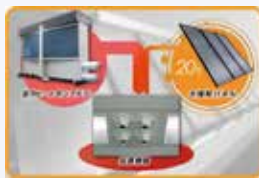
太陽熱の空調熱源利用
