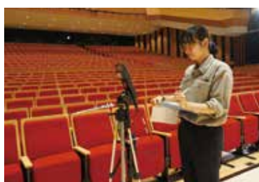
竣工時の温熱環境測定を実施中
