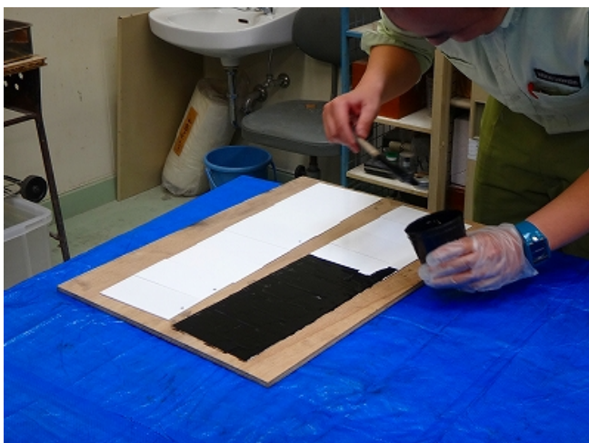
図-3 懸濁液の塗布状況 (左: 刷毛塗り 右: スプレー塗り)
