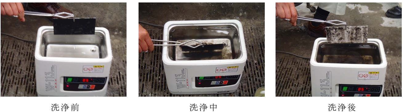
図-6 超音波洗浄の状況
