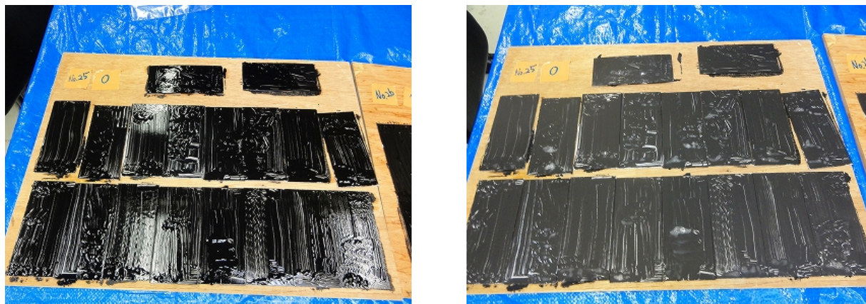
図-4 塗布後の表面の状況（左：塗布直後 右：1時間乾燥後）
