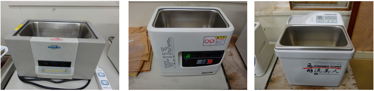
図-5 超音波洗浄機の例（左から、表-2の①～③）
