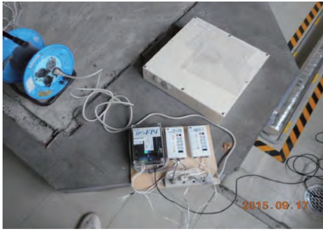
写真-5 感知器・無線機本体(2接点試作機)
