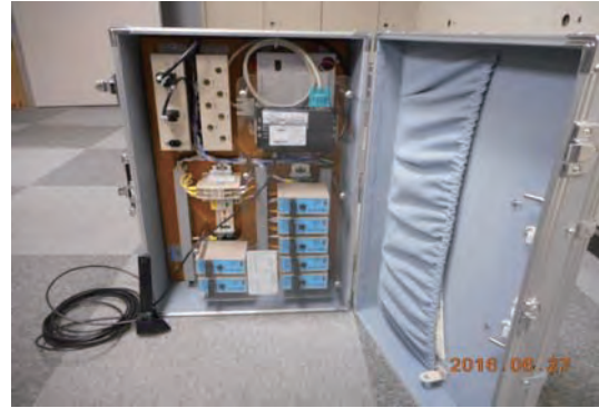
写真-6 最新の装置(7接点) ジュラルミン専用ケース入 W=400 H=600
