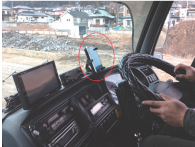
図-3 ダンプへのシステム搭載状況
