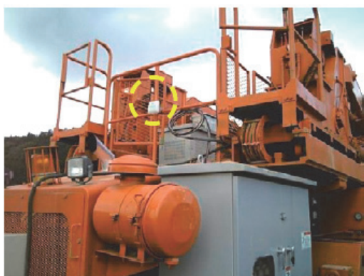
写真-9 データ伝送用アンテナ（ジャンボ搭載）
