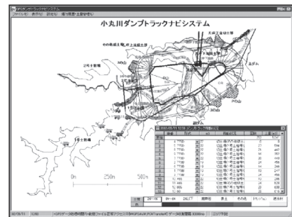
図-7 ダンプトラックナビシステム
