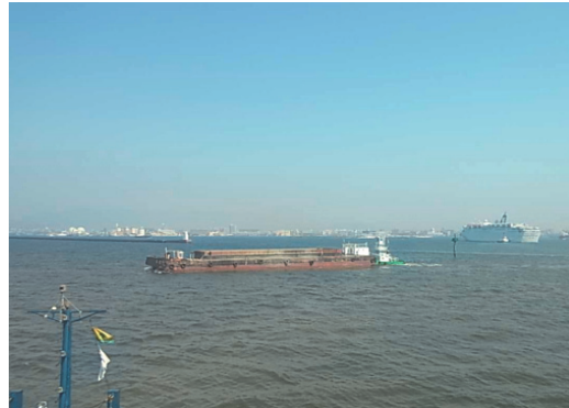
写真-2 浚渫土砂運搬状況
