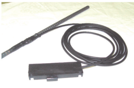
写真-3 ひずみセンサ部と RFID タグ
