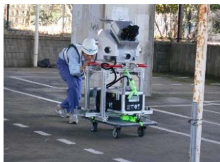
MMS 計測状況（台車）
