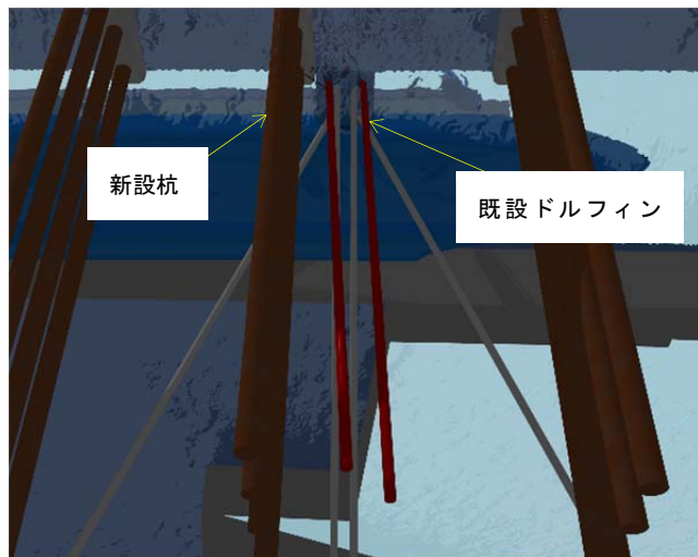
図 1 既存杭と新設杭の離隔確認図
