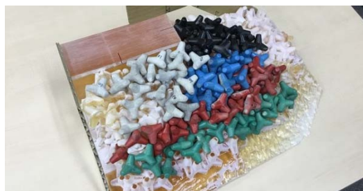
図-7 3Dプリント造形物+モルタル模型
