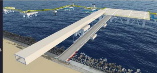
SfM 測量によって 3D モデル化した既設構造物との干渉チェック
