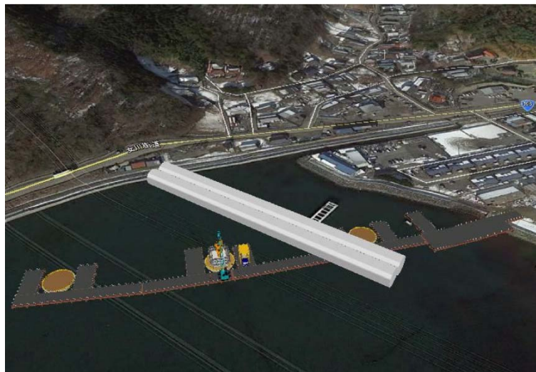
全体鳥瞰図 万石幹線制限範囲 (P3 施工時)
