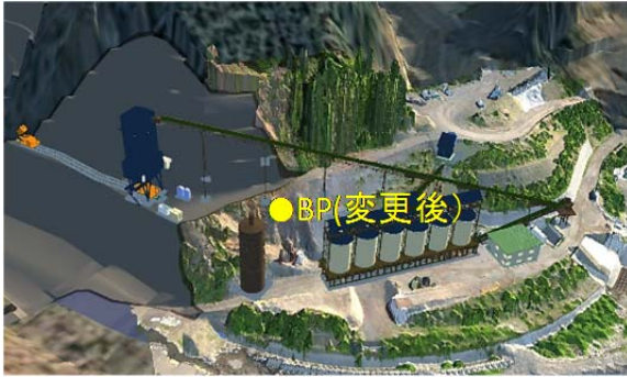
図-1 UAVによる撮影写真を用いた仮設備配置の検討
