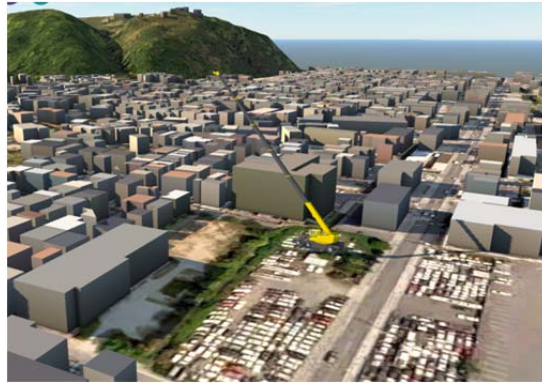
図3 3次元モデルを用いたクレーン配置状況(Infracworks360)
