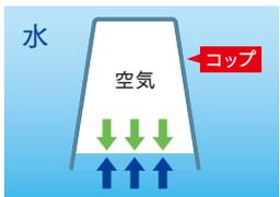
①まず、函体を地表面に置きます(コップを逆さに置きます)。基礎の一番下になる部分です。
