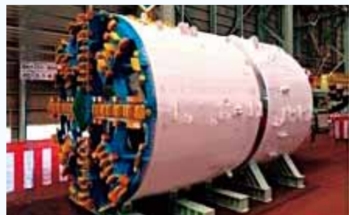
製造工場で組み立てられたシールドマシン。 青と黄色の部分がカッター。 カッターが回転して地盤を削り取る。
