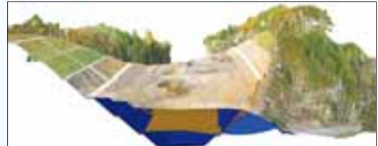
映像データを重ね合わせた3次元の地形図データ。スカナの性能にもよるが、数ミリ間隔で各地点の標高を、一度に測定することができる。
