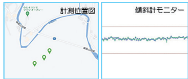
計測位置と情報をモニター画面で管理し、閾値を超えた場合にはアラートがなる
