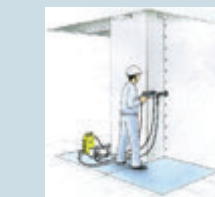
①柱表面の下部調整を行った後、壁にボルト貫通用の孔を穿孔する。
