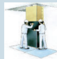
②エポキシ樹脂を含ませた炭素繊維シートを柱へ巻き付ける。
