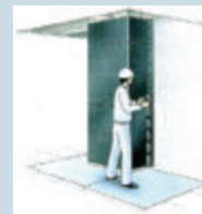
③巻き付けた炭素繊維シートの端部にADI金物を取り付け、通しボルトで締め付け固定する。
