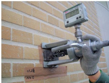
写真1 引張接着強度検査の状況
