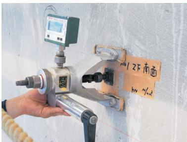
写真9 タイル下地引張り試験状況
