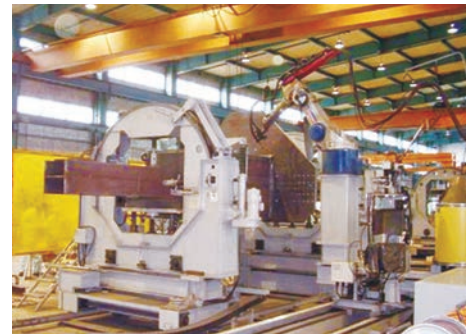
外ダイアフラムのロボット柱大組溶接
