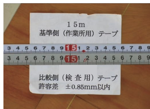
基準鋼製巻尺のテープ合わせ
