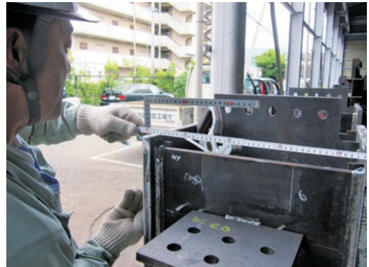
寸法検査状況
