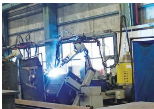
ロボット溶接
