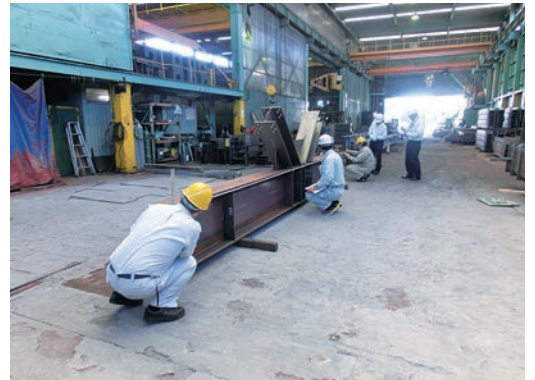
製品検査状況（寸法精度検査）
