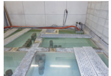
⑮ 養生水槽
