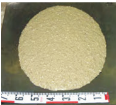
材料分離していない状態
