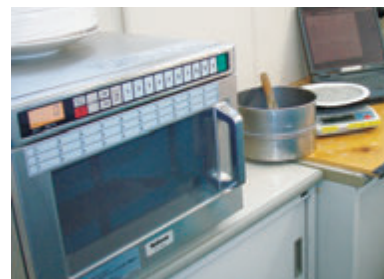
単位水量測定のための電子レンジ（高周波加熱乾燥法）
