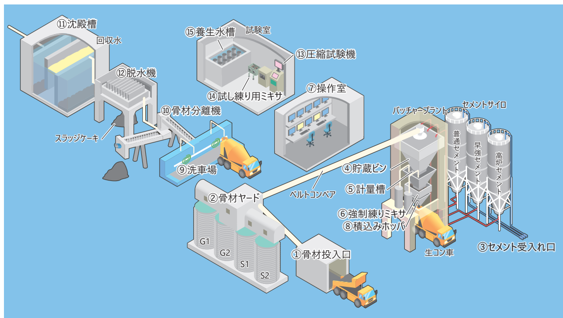
図1-1 生コン工場の設備概要図
