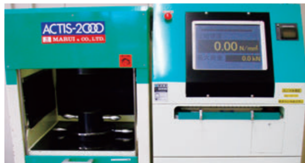
圧縮（耐圧）試験機
