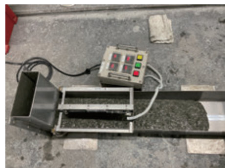
Ｌ型フロー試験 状況
