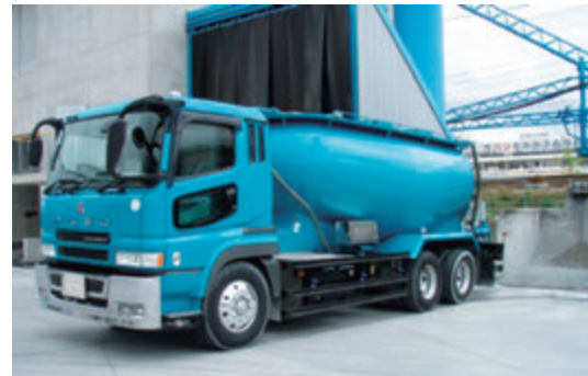
セメントの受入れ（セメントバラ車）
