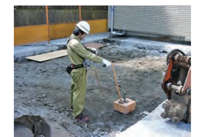
写真5 近・中距離対応型レーダーによる埋設物探査状況
