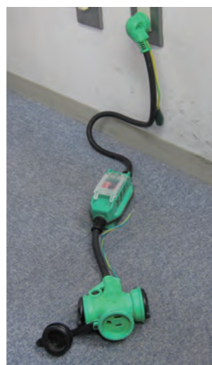
写真2 過負荷対応機能付漏電遮断器
