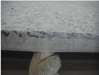
写真9 石材裏面処理 (小口マスキング)
