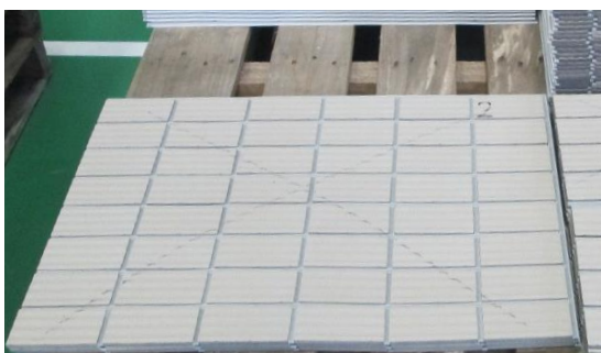
写真5 タイルパックの状況
