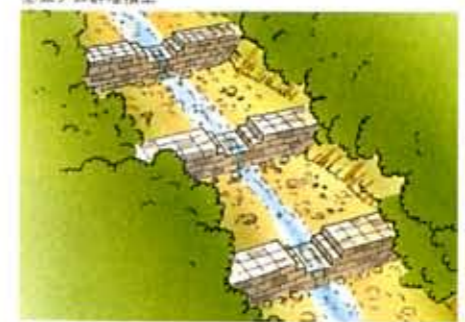
低いダムを連続させ、その中に土石流が堆積する。
