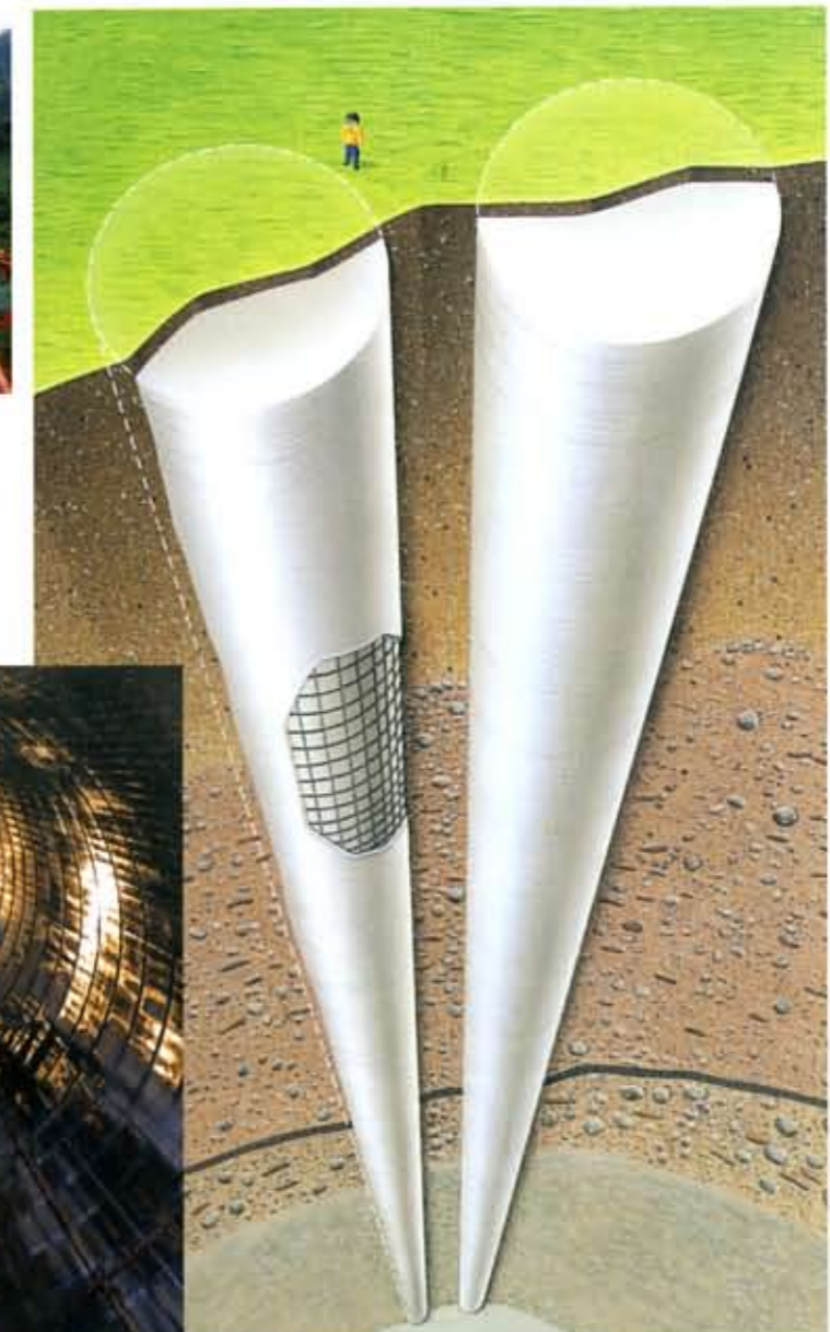
直径6.5m、長さ約100mに及ぶ鉄筋コンクリート杭が地中に並んでいる。
