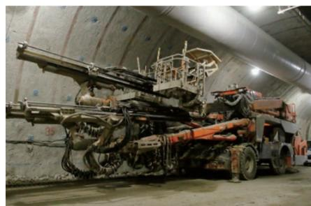
写真上/「さまざまな設備を活用し、省人化・効率化を図っています」と佐藤工業(株)の村山宏之所長。写真下/掘削を自動で行うことができるコンピュータジャング。予め設定したパターン通りに正確に削孔・掘削できる。3号トンネルでも導入。
