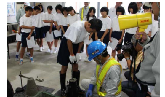
生コンクリートの流動性を確認する試験を体験
