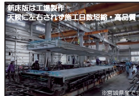
新壁高欄設置 床版と二分割のプレハブ化
