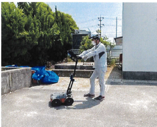
地下埋設物探査地中レーダーユーティリティスキャン スマート (キーテック) 使用 (寸法): 490×560×320mm・15kg
