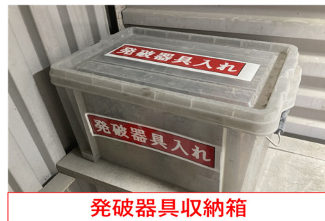
図-18 発破器用収納箱の設置
