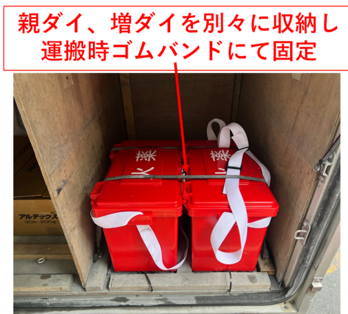
図-14 火薬運搬箱の固定
