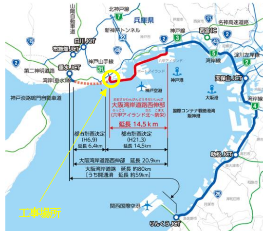
図1 大阪湾岸道路西伸部
