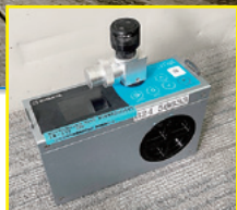
上：粉じん濃度測定6箇所 (切羽～10m、30m、50mの両側) 右：デジタル粉じん計 (PM4サイクロン付)
