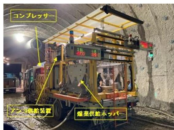
写真 1 遠隔装填装置
