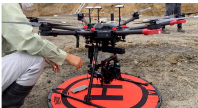
写真2 UAV 写真測量機材 (DJI Matrice600pro)
