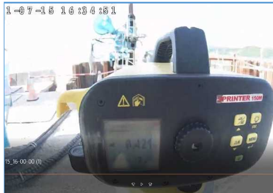
【電子レベルによる基準高の計測】
