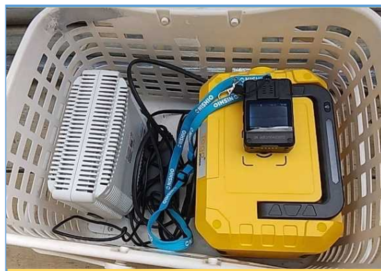
【屋内電波改善装置、ポータブル電源】
