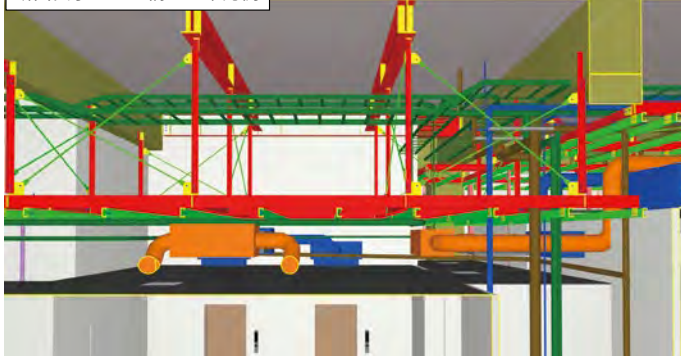
断面表示による納まり確認例
