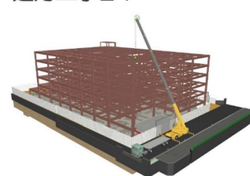
建方工事E・F
