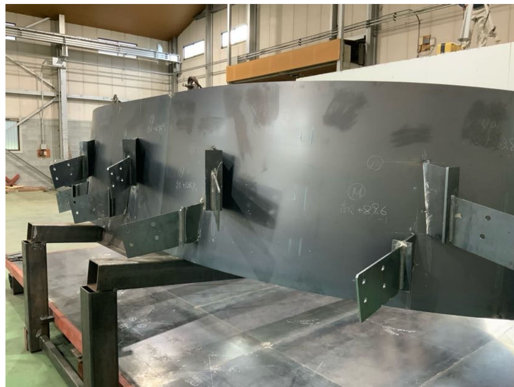
コンプレッションリング仮組検査状況
