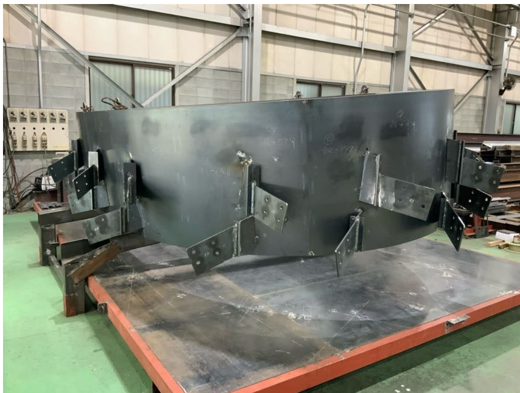
コンプレッションリング仮組検査状況
