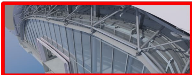
カーテンウォール（ACW）・トラス・膜の納まり調整
