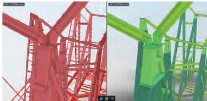
ACCによる検討モデルとFABモデルの比較
