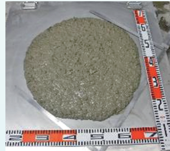
呼び強度 33 スランブフロー 55cm 増粘剤一液タイプ高性能 AE 減水剤の使用
