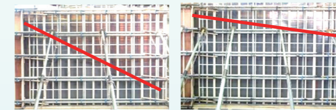
スランブ 18cm / 流動勾配・大 スランブフロー 50cm / 流動勾配・小 柱・壁模擬試験体による流動勾配の比較
