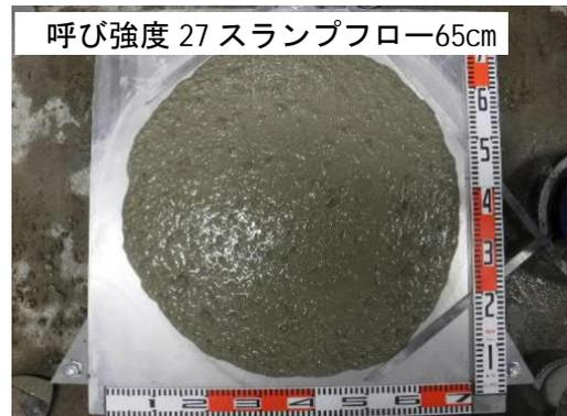
写真-2 スランプフロー試験後の状態
