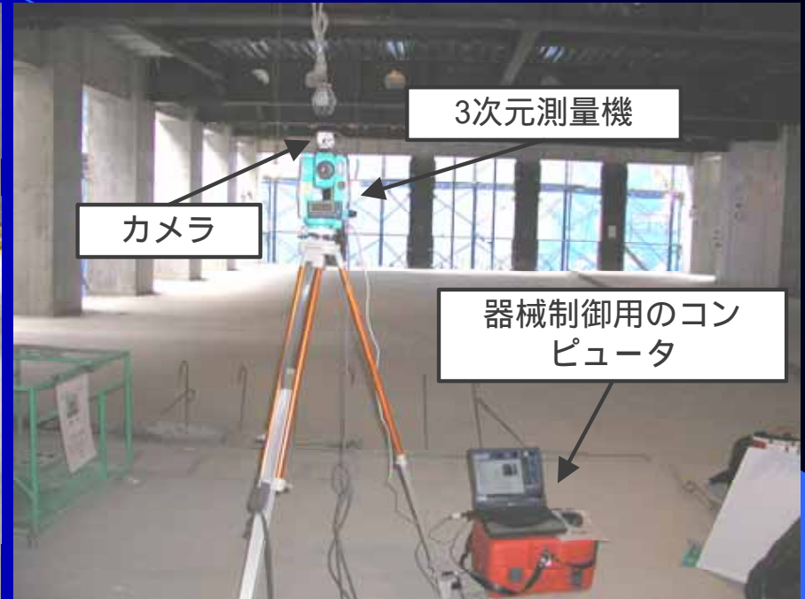
(b) 3次元測量による3次元座標の推定方法
