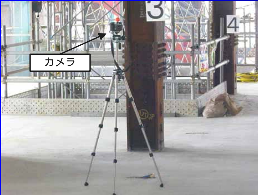
(a) 写真測量による3次元座標の推定
