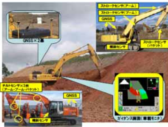
油圧ショベルのマシンガイダンスシステム技術(例)
